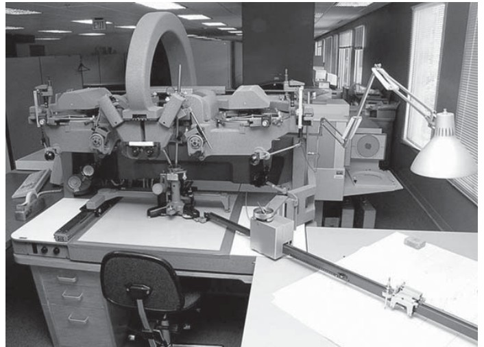
รูปที่ 1 เครื่องร่างแผนที่สามมิติ (Mechanical (analog) Stereoplotter)
