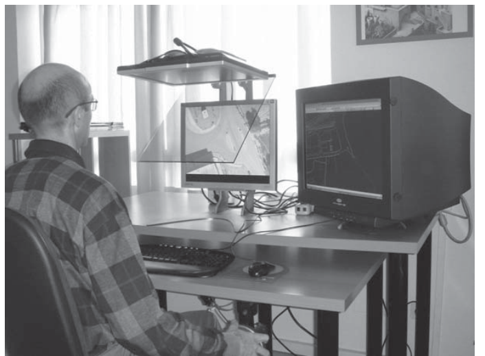
รูปที่ 2 เครื่องร่างแผนที่สามมิติแบบอัตโนมัติ (Automated Stereoplotter)
