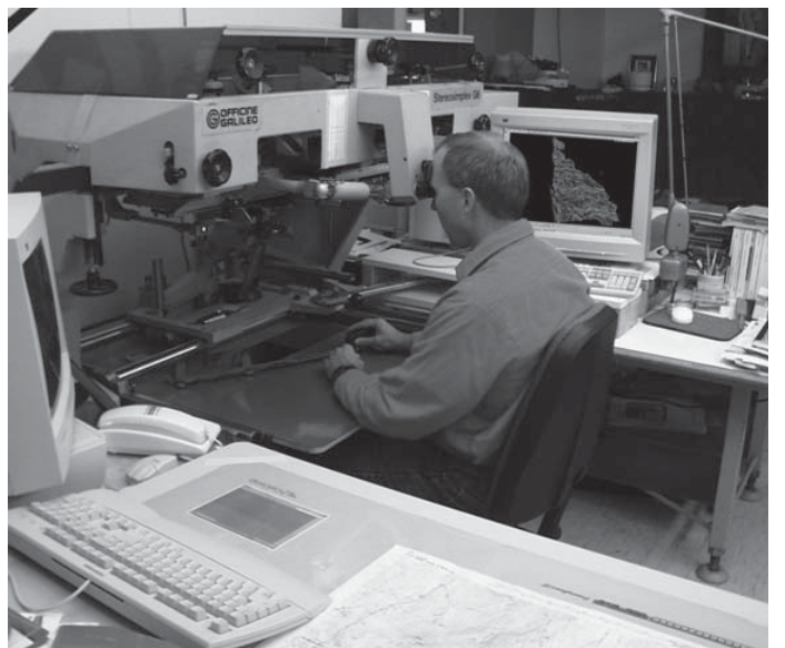
รูปที่ 3 เครื่องร่างแผนที่สามมิติแบบกึ่งอัตโนมัติ (Semi Automated Stereoplotter)
